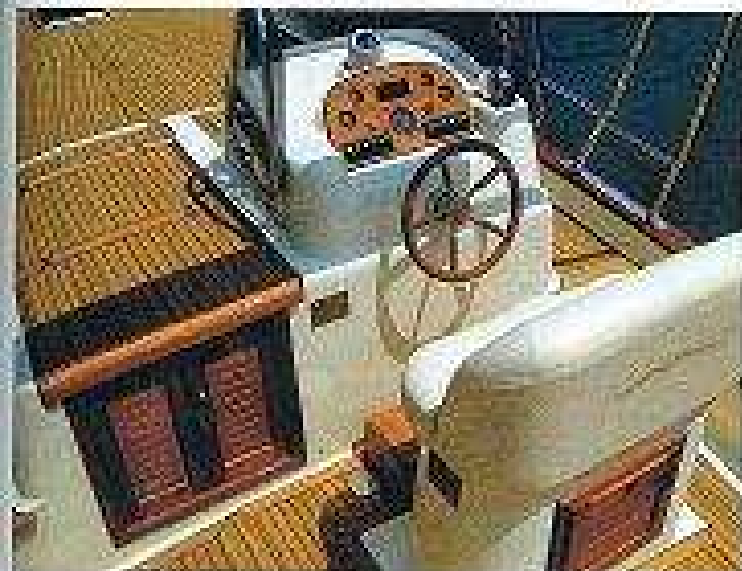
Cuenta con un puesto de gobierno sencillo desplazado a estribor.
