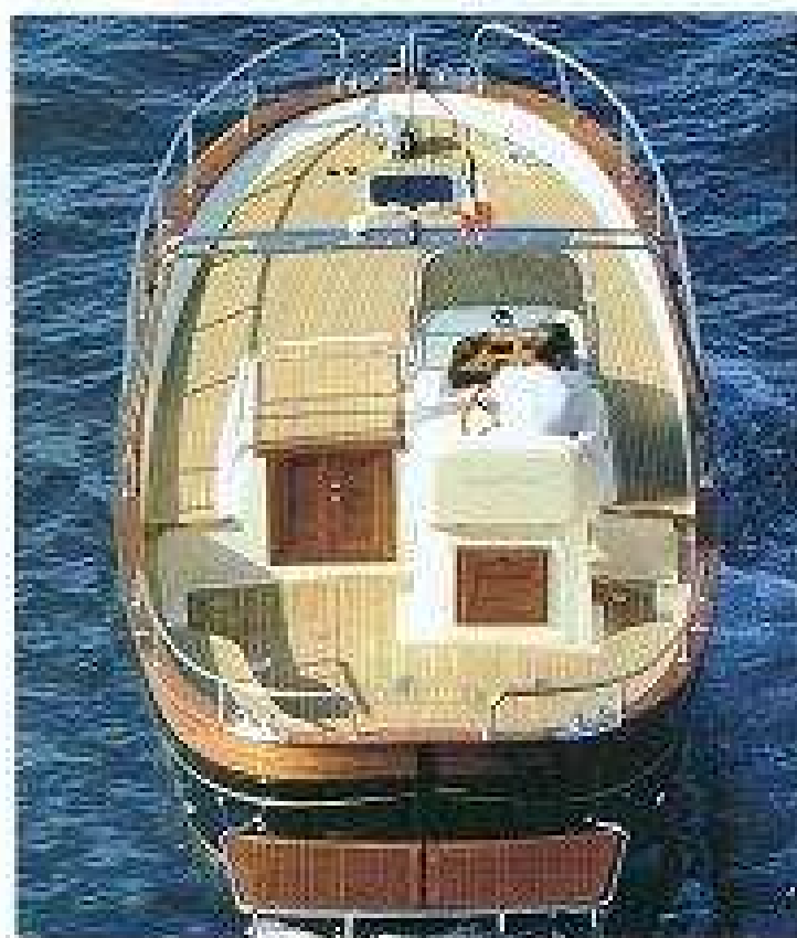
Adopta en popa una plataforma de baño de estructura tubular adosada.
